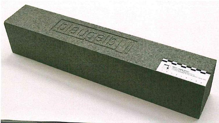
Bild 1: „blaugelb Triotherm<sup>+</sup> Profil“ (zugeschnitten auf 500 mm)
