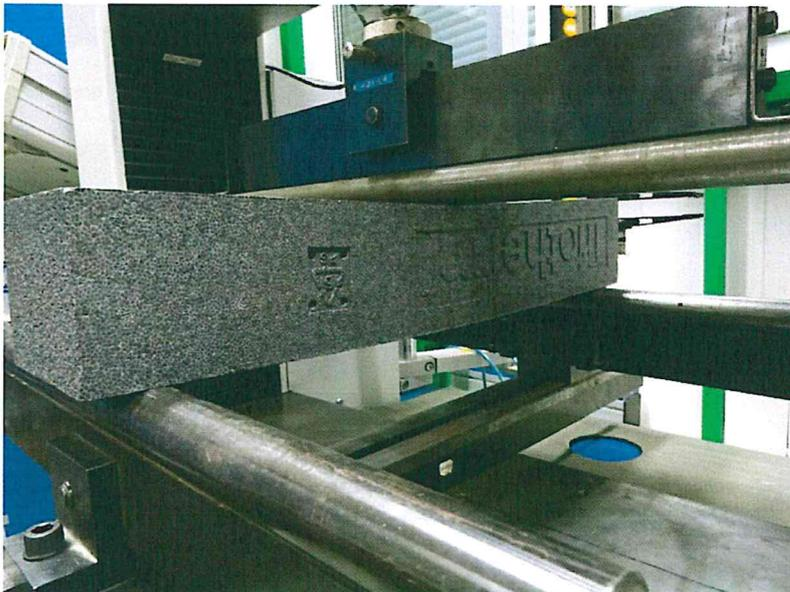
Bild 7: Prüfung der Biegefestigkeit – Versuchsaufbau (exemplarische Darstellung)
